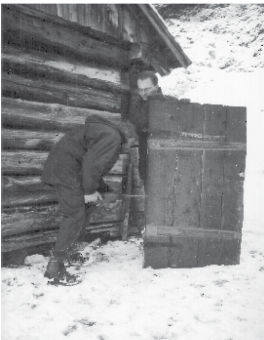
Abb. 4, Verbautes Holz aus Almhütten kann datiert und für dendroklimatologische Zwecke verwendet werden. Hier wird mit dem Hohlbohrer eine Probe entnommen. (Foto F. Mandl)
