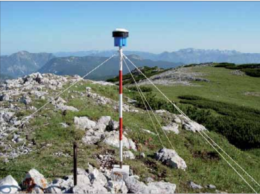
Abb. 5: Aufstellung mittels Lotstab
