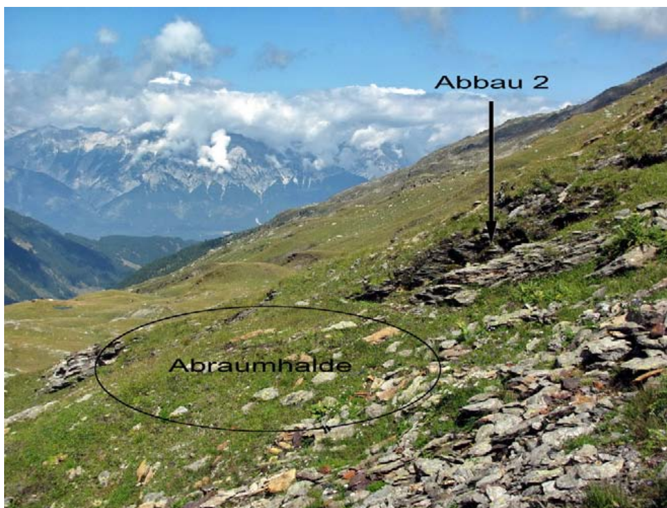
Abb. 38: Situation von Abbau 2, verstärzter Stollenanschlag an Felsriegel 20 m westlich des offenen Mundloches Fundobjekt Nr.18
